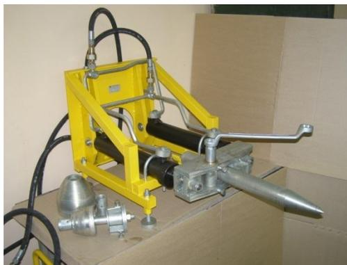
Рис. 3. Грунтопрокалывающая установка статического действия НПП «Газтехника»
