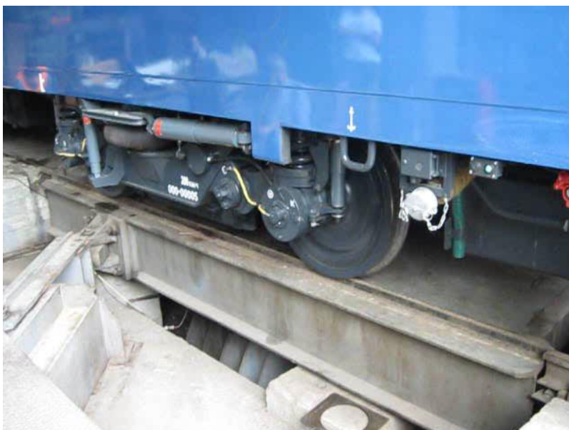
Рис. 5.1. Приклад стендового обладнання для визначення моменту опору повороту візка відносно кузова (Лабораторна база Інституту залізничного транспорту, м. Варшава)
