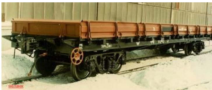
Рис. 1. Универсальная вагон платформа модели 13-4012
