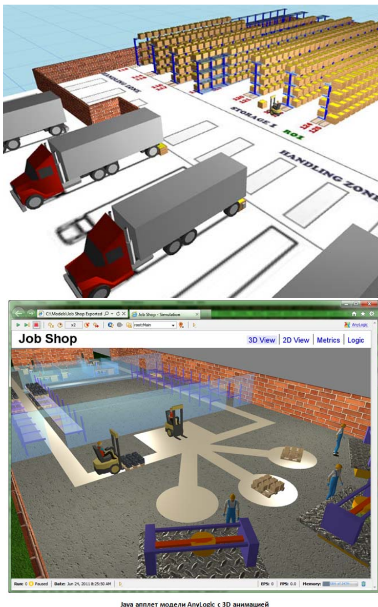
Рис. 1. Моделирование работы грузового терминала при помощи AnyLogic
