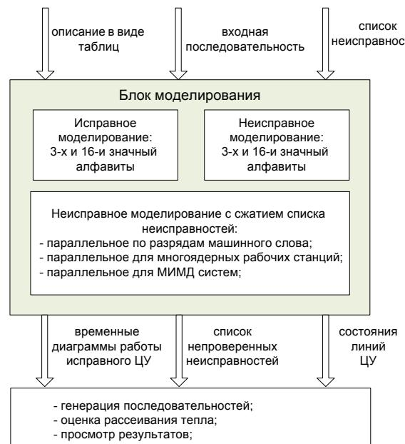
Рис.3. Подсистема моделирования и её входные/выходные потоки данных
