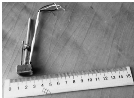
Рис. 5. Опорна поверхня датчика з елементами кріплення
