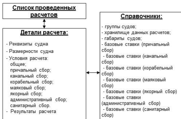
Рис. 1. Структура информационной базы данных программы расчета
