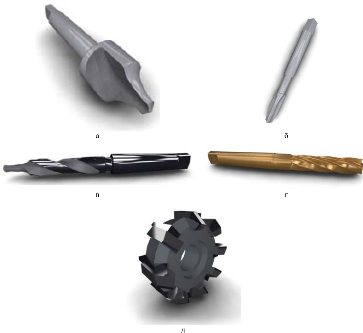
Рис. 5. Режущие инструменты с рендерингом: а – фасонное сверло; б – метчик; в – сверло спиральное; г – развертка; д – фреза торцовая
