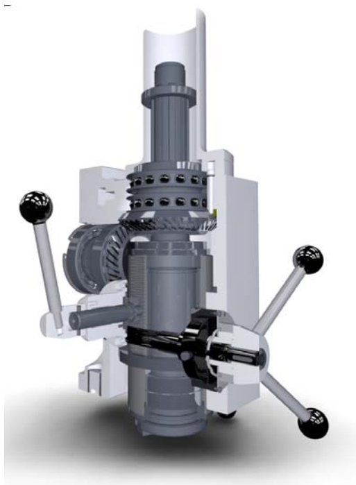
Рис. 9. Рендеринг вертикальной шпиндельной головки
