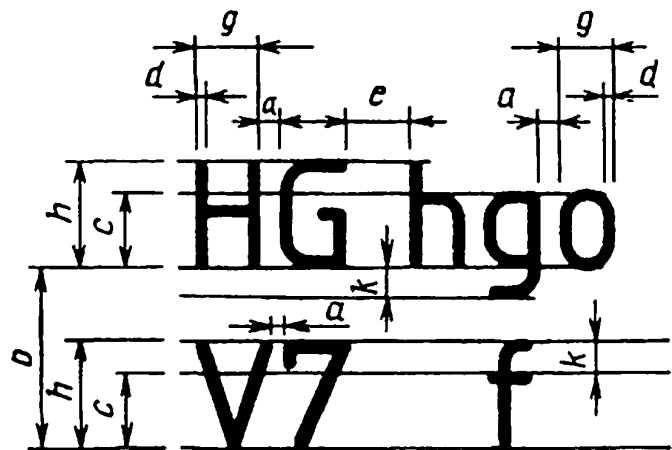
Рис. 1.13. Визначення розміру, товщини лінії і ширини букви шрифту без нахилу
