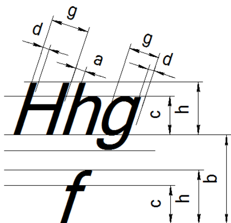
Рис. 1.12. Визначення розміру, товщини лінії і ширини букви шрифту з нахилом
